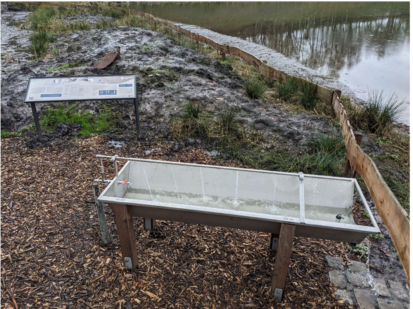
Abb. 15: Mit Teichwasser gespeiste Schlämm-Anlage zum Auswaschen von Fossilien aus Tonproben. Eine super Idee!
