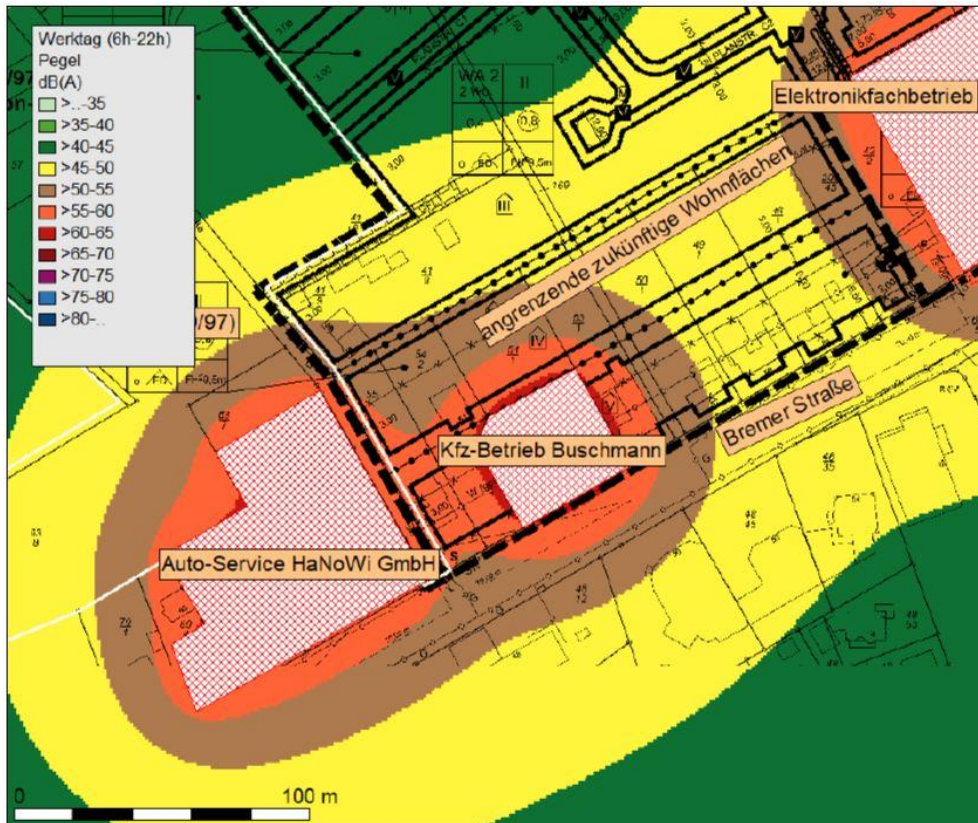
Abbildung 11: Ergebnisdarstellung der Pegelausbreitung ausgehend von der Fa. Buschmann, werktags (Quelle: itap, Gutachten vom 23.01.2020)
